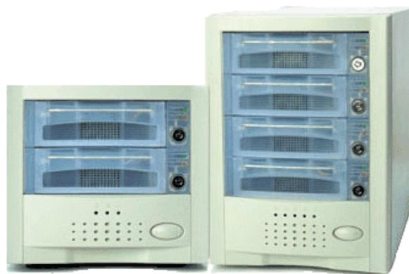
Ils contiennent généralement plusieurs disques durs le plus souvent avec une interface SCSI. Les NAS permettent de mettre en place le RAID très facilement. On peut ainsi obtenir des unités de stockage très fiables et faciles à mettre en place. En effet, les serveurs de fichiers qui utilisent « une machine complète » ont beaucoup plus de chances
