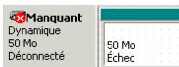
Ci-contre, l'un des disque dur d'un volume agrégé par bande est mal branché (suite à une manipulation à l'intérieur du boîtier par exemple), il porte l'attribut : « manquant ».
