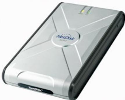
Ci-contre le Netdisk de la marque Ximeta est un disque dur NDAS. Il contient un disque dur de 80, 120 ou 160Go (selon les versions) tournant à 7200tr/min et possédant 2Mo de cache. Il peut se raccorder à une machine ou au réseau grâce à un port USB 2.0 ou bien grâce à une prise RJ45. De plus on peut le paramétrer avec une interface web.
